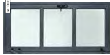
Porte 1 vantail avec deux traverses intermédiaires.
