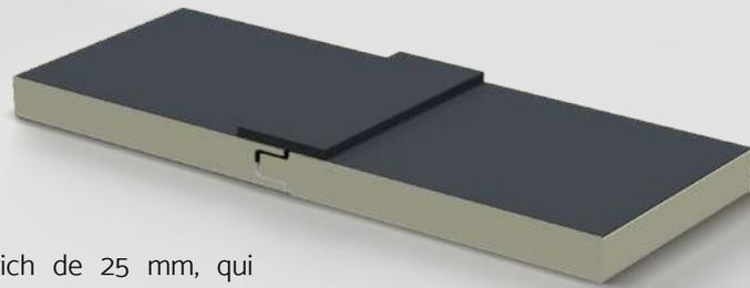
Elle est réalisée en panneaux sandwich de 25 mm, qui se composent de deux matériaux. La partie centrale est faite d'isolant, pour une meilleure protection thermique et phonique, recouverte dessus et dessous, de tôle d'acier pour une résistance optimale au choc.
